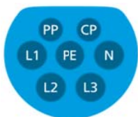
Abbildung 11: Steckertyp 2 für AC Ladung nach IEC 62196
