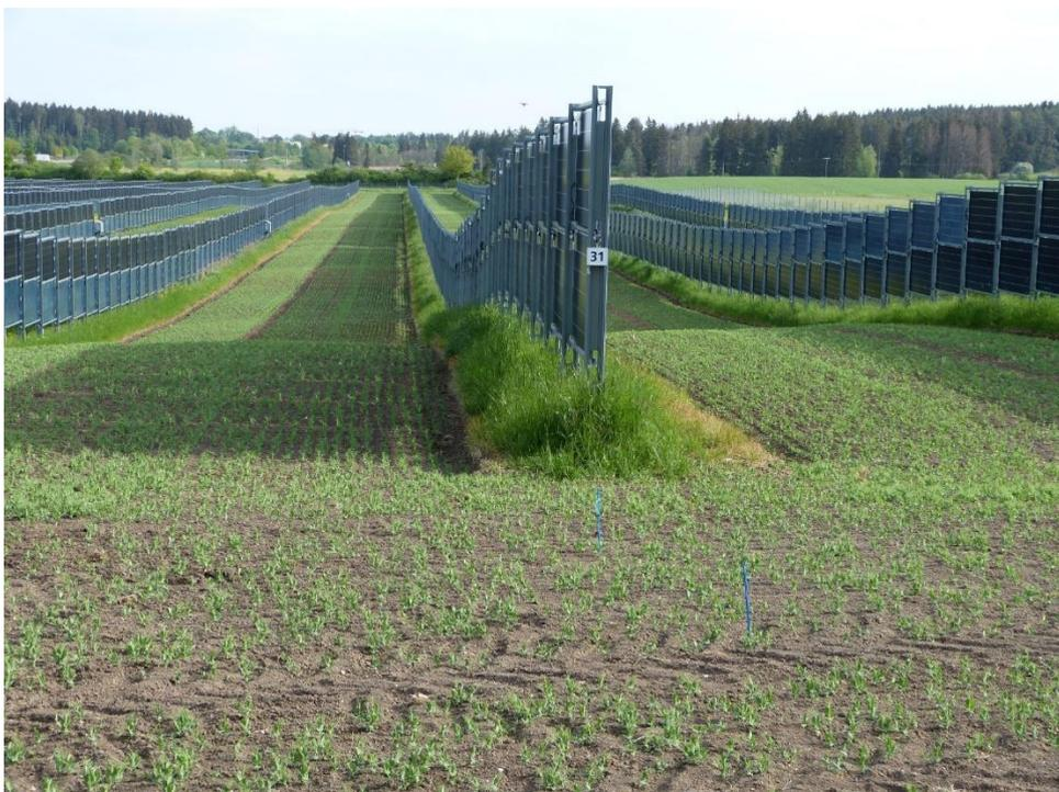
Abbildung 13: Ansicht des Erbsenanbauversuchs in der Agri-PV Anlage in Donaueschingen-Aasen nach dem Auflaufen der Erbsen, am 13. 5. nachmittags (oben, Schatten links) und am 16.5. 2022 vormittags (unten, Schatten rechts).
