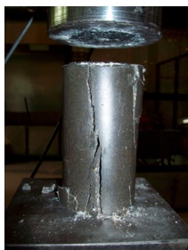
Abb. 2: Polymerbetonprobe nach der Druckprüfung auf Polyester- und Epoxidbasis
